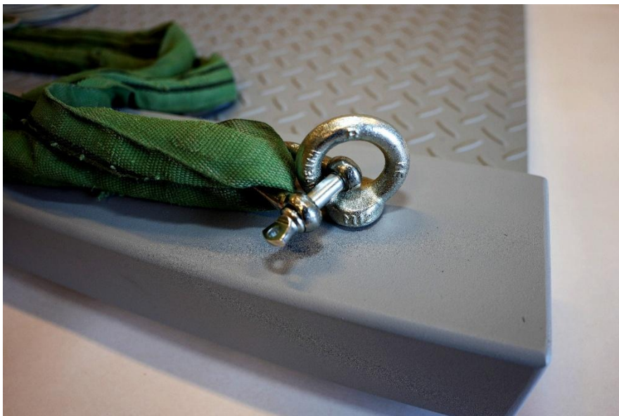
Bild 2. Lyftögla monterad med lyftanordning
